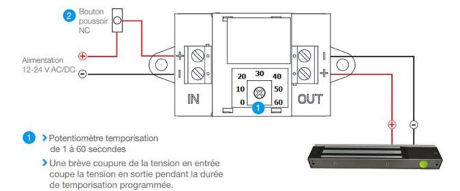
2 > Le bouton poussoir NC peut être remplacé par tout autre type de dispositif de commande disposant d'un contact NC (horloge, clavier à codes, lecteur de proximité,...).
