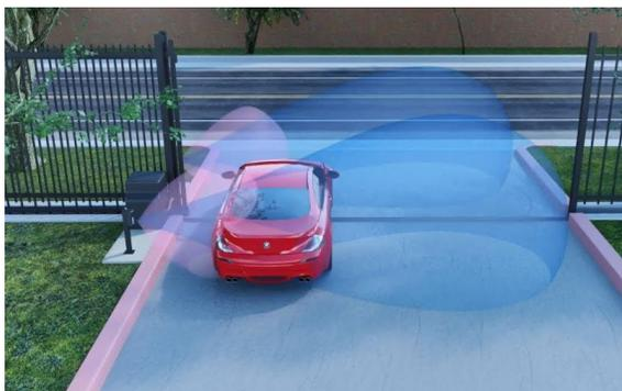
L'OVS01GT est conçu pour détecter de façon fiable la présence d'un véhicule à l'arrêt ou se déplaçant et ayant aussi la capacité d'ignorer le déplacement d'humains.
