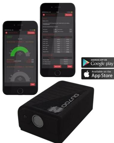
Les informations collectées par le module de diagnostic DU700 et l'application pour smartphone peuvent être utilisées pour vérifier le bon fonctionnement d'une installation de détecteur de boucle inductive.
