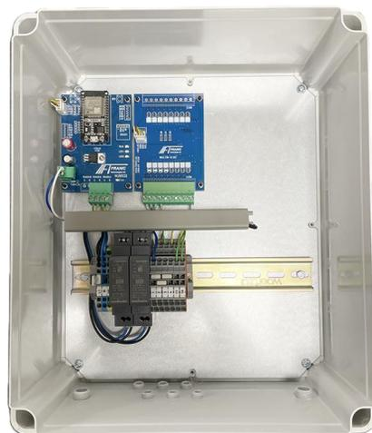
L'automate de comptage NUMX32 fonctionne en complète autonomie. Son architecture modulaire lui permet de s'adapter au mieux à chaque installation.
