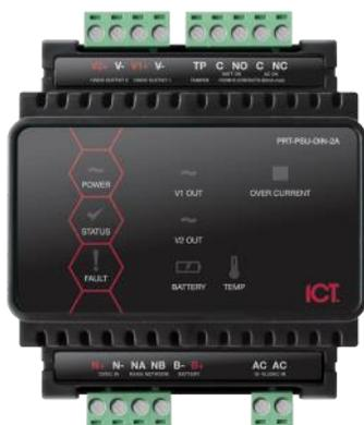
Le module I-PRT-PUSU2A délivre une alimentation de 12 VDC 2A, idéale pour alimenter des dispositifs de sécurité, de contrôle d'accès ou d'automatisation, ainsi qu'un grand nombre de modules alimentés par le bus Protege de la même installation.
